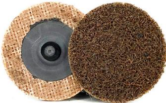
Гибкие шлифовальные круги ROXPRO позволяют получить однородную поверхность высокого качества. Нетканые круги ROXPRO предназначены для понижения риски, доводки поверхности, подготовки под окраску и финишной обработки. Они также могут использоваться для удаления ржавчины, старых покрытий, мелких заусенцев, следов станочной обработки. Нетканые круги ROXPRO практически не засаливаются и могут использоваться для обработки мягких металлов.
