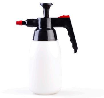
Ручной распылитель предназначен для удобного нанесения очищающих составов – обезжиривателей на органической и водной основе. Состав подается в распыляющую насадку с помощью нагнетательного насоса. Равномерное распределение жидкости по поверхности детали обеспечивает особая геометрия сопла. Распылитель укомплектован бачком объемом 1 л, изготовленным из специальной пластмассы, стойкой к воздействию химических составов.
