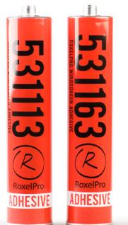
Однокомпонентный полиуретановый клей-герметик для автомобильных лобовых стекол. Обладает отличной прочностью и адгезией. Время полной полимеризации – 24 часа при толщине слоя 3.5 мм, температуре 23°C и относительной влажности воздуха 50%.
