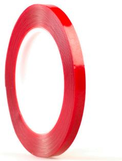
Двусторонняя акриловая клейкая лента повышенной прочности. Применяется для соединения различных материалов: дерево, металл, пластик, стекло и т.д. Склейываемые поверхности должны быть тщательно очищены. Максимальная прочность будет достигнута через 72 часа. Спустя 3 часа прочность будет составлять 75%.
