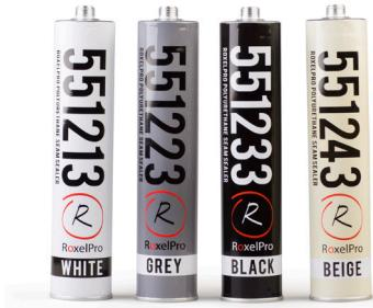
Многоцелевой однокомпонентный полиуретановый герметик применяется для защиты поверхностей и швов. Обладает отличной упругостью и адгезией к большинству материалов. После отверждения может окрашиваться. Не стекает при нанесении и быстро полимеризуется под воздействием естественной влажности воздуха.
