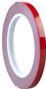
Двусторонняя акриловая клейкая лента повышенной прочности. Применяется для соединения различных материалов: дерево, металл, пластик, стекло и т.д. Склейываемые поверхности должны быть тщательно очищены. Максимальная прочность будет достигнута через 72 часа. Спустя 3 часа прочность будет составлять 75%.
