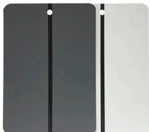
Металлические пластины с полосой для тестирования автомобильных красок. Черная полоса на пластине позволяет оценить укрывающую способность красок. Пластины пригодны для тестирования любых красок, в том числе водоразбавляемых.
