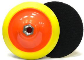
Оправки изготовлены из высококачественного пластика, выбранного в соответствии с требованиями к весу, стабильности и износостойчивости, что позволяет свести до минимума вибрацию во время работы. Возможно применение на промышленных угловых шлифовальных машинах с регулятором числа оборотов или на малооборотных шлифовальных машинах с резьбой М14.
