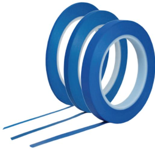
Маскировочная лента Fine Line - это маскировочный материал, изготовленный из термически стабилизированного полихлорвинила с клеевым слоем на основе каучука. Лента Fine Line применяется для создания четких и ровных декоративных разделительных линий различной толщины. Легко наносится на металлические части, резину, стекло, хромированные детали, OEM / ремонтные покрытия, автомобильные пластики.
