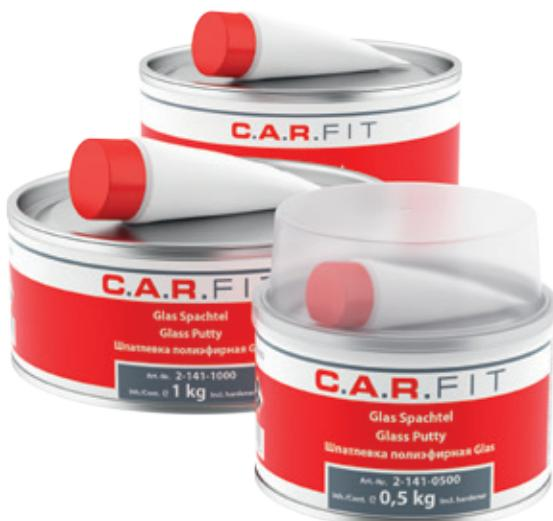
Двухкомпонентная полиэфирная шпатлевка, усиленная стекловолокном. Используется для заполнения небольших отверстий и участков кузова, поврежденных коррозией, а также глубоких неровностей. После высыхания материал становится очень прочным и при необходимости может быть отшлифован. Применяется в процессе кузовного ремонта автомобилей.
