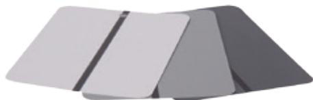
Металлическая загрунтованная пластина размером 105x150 мм с полосой для тестирования автомобильных красок.
