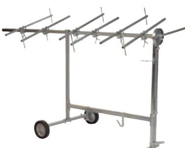
Мобильный окрасочный стол. Используется для фиксации дверей, капотов, крышек багажников и т.п. Поставляется в комплекте с шестью удлинителями. Оборудован держателем окрасочного пистолета.
