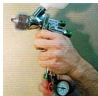
Регулятор давления установлен на 2 бара для базового слоя, на 2,5 бара для покровного слоя
