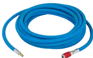
Высококачественный воздушный шланг для подключения окрасочных пистолетов Внутренний диаметр 9 мм, длина 10 м, с быстроразъемной муфтой и ниппелем, с антистатическими свойствами, не содержит веществ, нарушающих лакокрасочное покрытие, выдерживает давление в 20 бар, высокая прочность на разрыв. Номер артикула 53090
