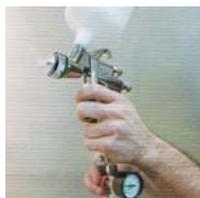
Регулятор давления установлен на 2 бара для HVLP, на 2,5-3 бара для стандартной версии
