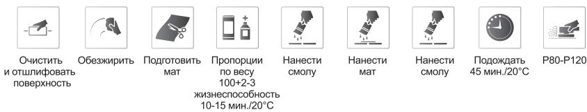
Полиэфирная смола используется для ручного ламинирования. PLUS 720 содержит конструктивную полиэфирную смолу и добавку соответствующих катализаторов. Отвердителем для смолы служит 50% паста из перекиси бензоила (NOVOL арт. № 5022). Данный продукт предназначен для ремонта значительных по величине дыр и проржавевших мест из жести, ремонта пластиковых деталей автомобильного кузова, а также ремонтов яхт и кемпинговых прицепов.
