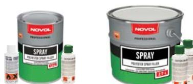
Отделочная шпатлевка, наносимая пневматическим пистолетом. Позволяет получить большое заполнение, сохранив при этом гладкость покрытия на очень больших поверхностях. Время её затвердевания составляет около 2 часов, однако время можно сократить, увеличив температуру не выше 60°C. Шпатлевка применяется как для механической так и ручной обработки мелкозернистой наждачной бумагой.
