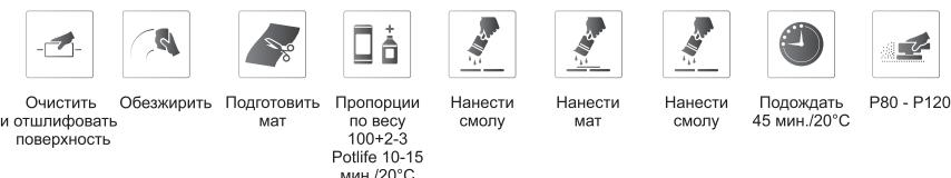
Комплект состоит из полиэфирной смолы, отвердителя и стекломата. Образованный из него пластик обладает очень высокой механической прочностью и предназначен для заполнения значительных убытков материала (вызванных например коррозией), для укрепления и фиксации металлических, а также пластмассовых поверхностей. После отвердевания может шлифоваться и покрываться любыми полиэфирными шпатлевками для получения необходимой гладкой поверхности.
